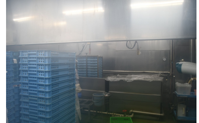
2:X線で骨の残を確認後表面殺菌を行います。 他ではやらない工程です。 90度で2分行います。 この後急速に冷しこまれ、パッケージされます。
