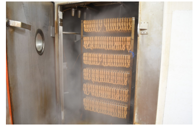
4:加熱処理をし冷却します。 ウインナーの場合78度で35分行い その後80度で5分行います。→「これだけやればO-157も 死ぬよ!」と言っておりました。 ※ハム・ベーコンはこの作業を温度を変えて2時間半行われています。
