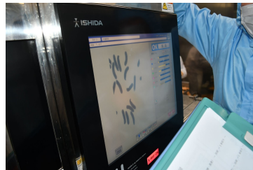
2:X線で骨の残を確認後表面殺菌を行います。 他ではやらない工程です。 90度で2分行います。 この後急速に冷しこまれ、パッケージされます。
